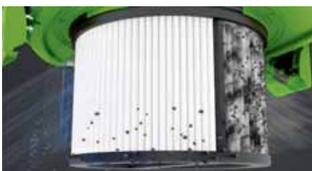
Automatische filterreiniging elke 45 seconden
